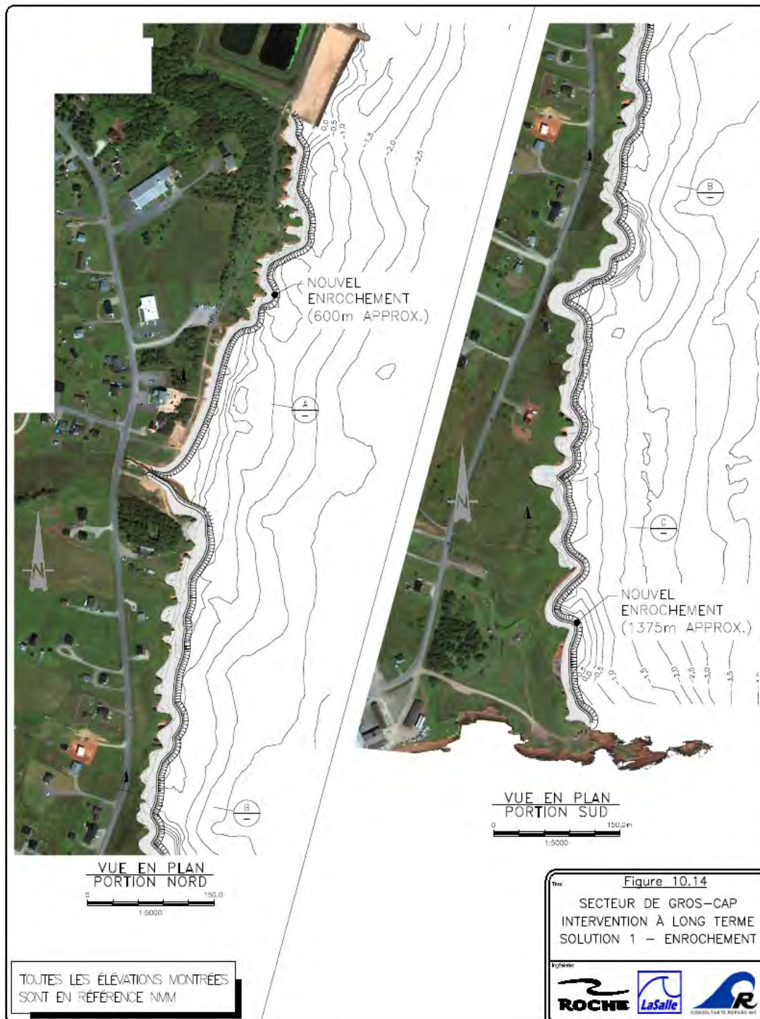
Figure 10.14 – Intervention à long terme – Solution 1 – Enrochement – Vue en plan
